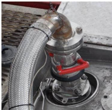
Nel sito produttivo, Blue Cube Chemicals Italy utilizza i “Dry-Connection” per il collegamento dei flessibili di scarico e dei flessibili di pressurizzazione con azoto delle cisterne.
